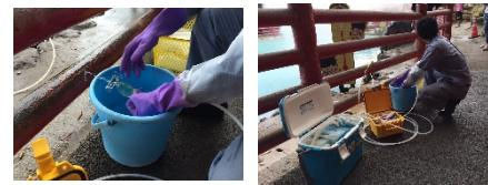
地獄の池の水深2m程度まで、専用の採水チューブを投げ込み、クーラーとペリスタポンプを用いて、空気が入らないように両口ガラス容器に温泉水を採取した。測定は東京大学にてVG5400(MS-III)を用いて行った。
